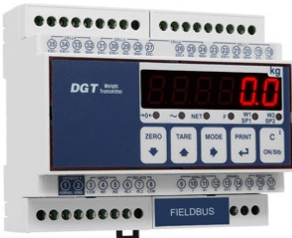
Trasmettitore di peso a 4 canali per la trasmissione del peso al PLC tramite bus di campo, uscita analogica o RS485. Permette la lettura e la diagnostica di ogni cella di carico o di ogni bilancia collegata (fino a 4).
