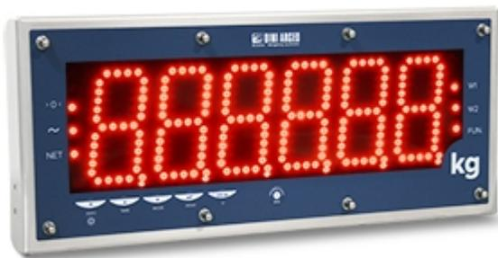
Indicatore / Ripetitore di peso con grande display a matrice di LED superluminosi ad alta intensità. Particolarmente adatto per utilizzo in ambiente esterno, è ben visibile anche in piena luce solare e dove occorre avere una lettura del peso a distanza da qualsiasi angolazione. Custodia completamente in acciaio INOX AISI 304 con protezione IP68.
