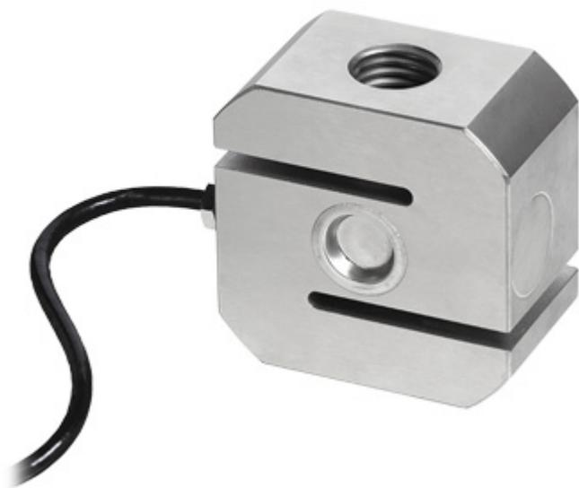
Celle di carico a trazione/compressione, ideali per la pesatura in trazione di carichi sospesi e come controllo e limitazione di sovraccarico, oppure per utilizzo in compressione per la realizzazione di sistemi di pesatura a più celle di carico.
